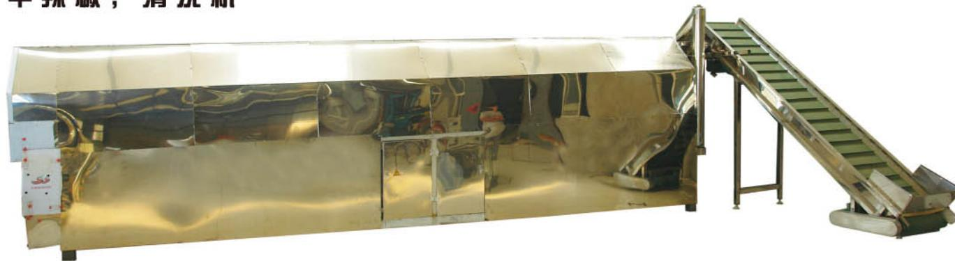
干辣椒，清洗机利用旋转摩擦方式，将辣椒表面砂尘灰土清洗干净，达到食用和出口标准。
